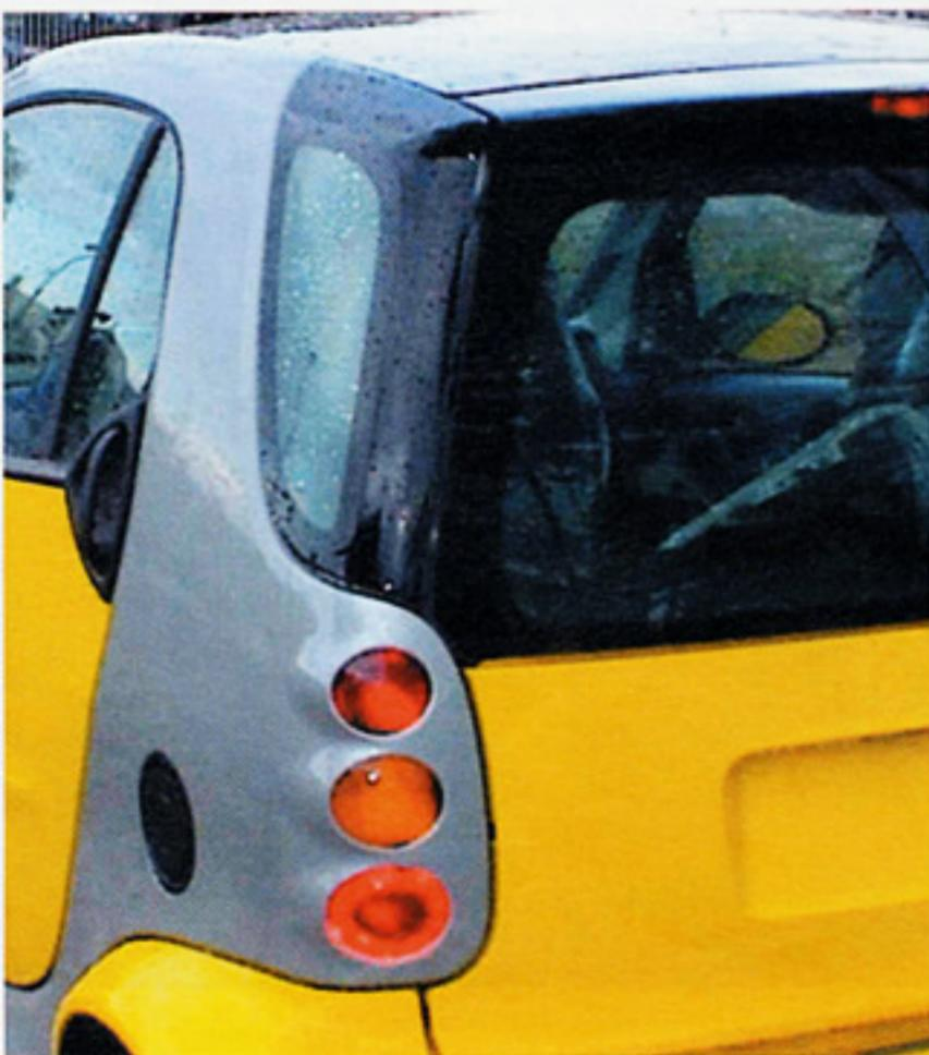
*Bild 2 Design ohne Bruch: Fortführung der Gestaltungselemente C-Säule, Dachmodul, Spoiler, Heckklappe und Rückleuchte in der hinteren Seitenscheibe*
