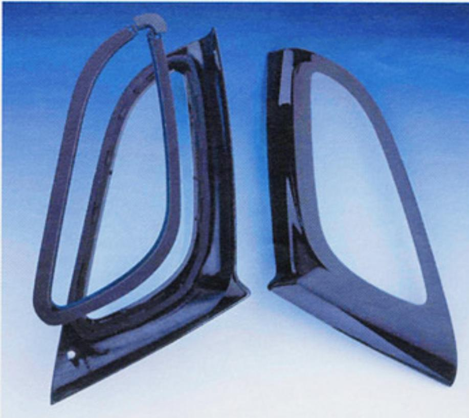
*Bild 4 Im Zwei-komponenten-Spritzguß gefertigte Scheibe hoher Brillanz und Tiefenwirkung bildet mit Montagerahmen, Halterahmen und Clip eine Einbaueinheit*
