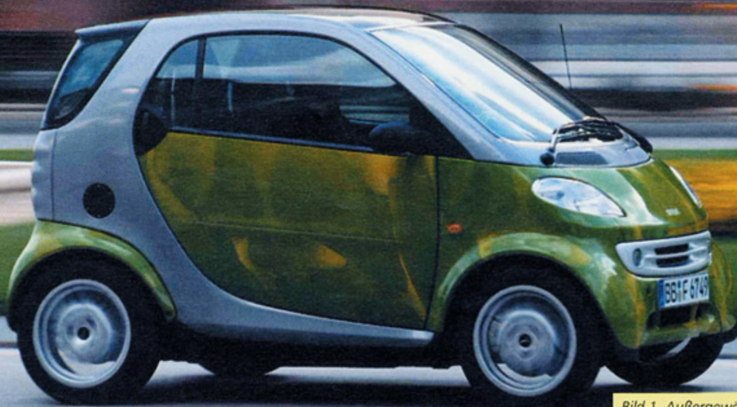
*Bild 1 Außergewöhnliches Design erfordert mitunter außergewöhnliche Fertigungsmethoden: Die hinteren Seitenscheiben bestehen aus hochwertigen Kunststoffen (Bild: MCC, Renningen)*
