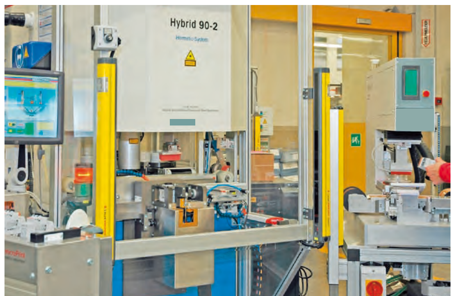
Die 2-farbige Hybrid 90-2 Tampondruckmaschine wird zur Zweiseiten-Bedrucker eingesetzt; rechts die Tampondruckmaschine für den zusätzlichen Logo-Aufdruck.
